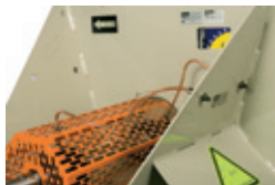
Engrasadores externos para facilitar el mantenimiento
